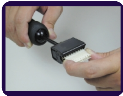
第四步： 将四对或五对端子板放入五对打线工具的打接头上。
