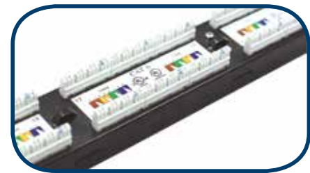
增大IDC端子间隔可以改善串音性能
