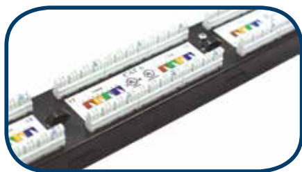
增大IDC端子间隔可以改善串音性能
